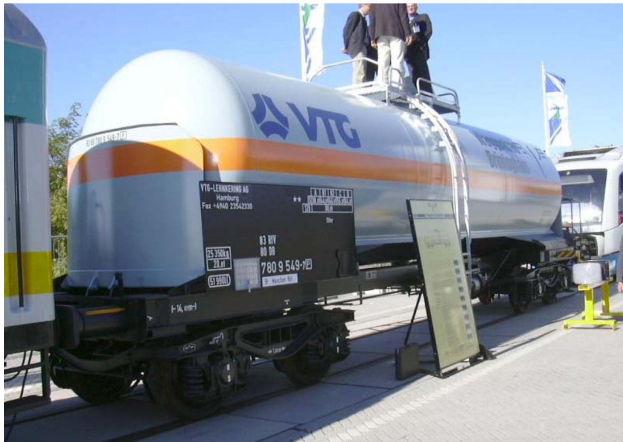
Ochranné štíty na voze VTG. Na snímku jsou patrné i crash nárazníky (TE 22). Zdroj: www.railfaneurope.net
