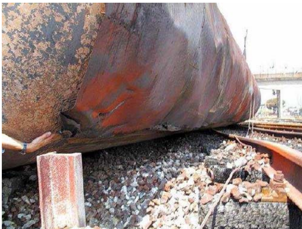
místo a příčina proražení nádoby cisternového vozu – z toho místa unikal zkapalněný LPG
